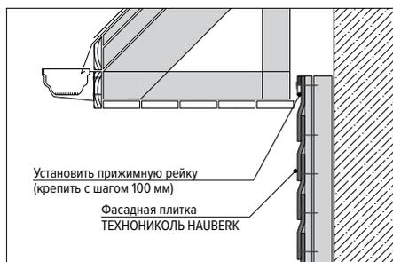
Рис. 9.1. Монтаж верхнего ряда под карнизным свесом. Вариант 1
